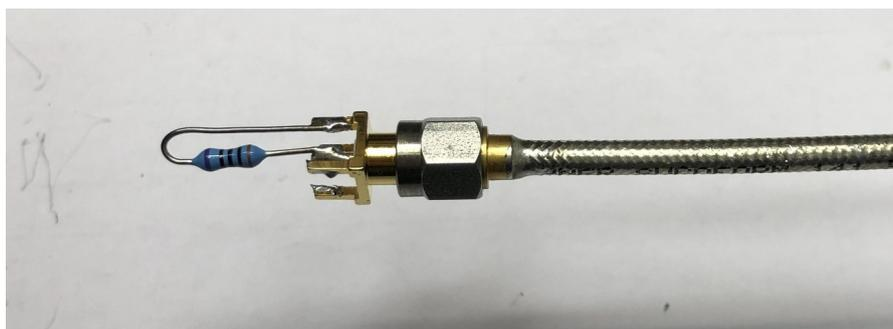
Figura 11.2: Resistore a film metallico 100 Ohm
