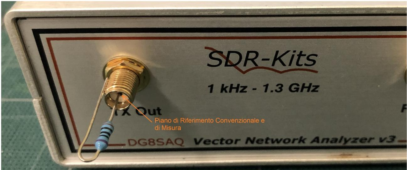
Figura 6.1: R 100 Ohm sul Piano Convenzionale di Misura
