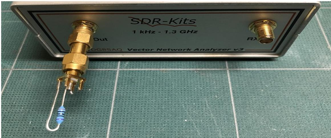
Figura 6.3: Connettore SMA-F per PCB con adattatore SMA M-M
