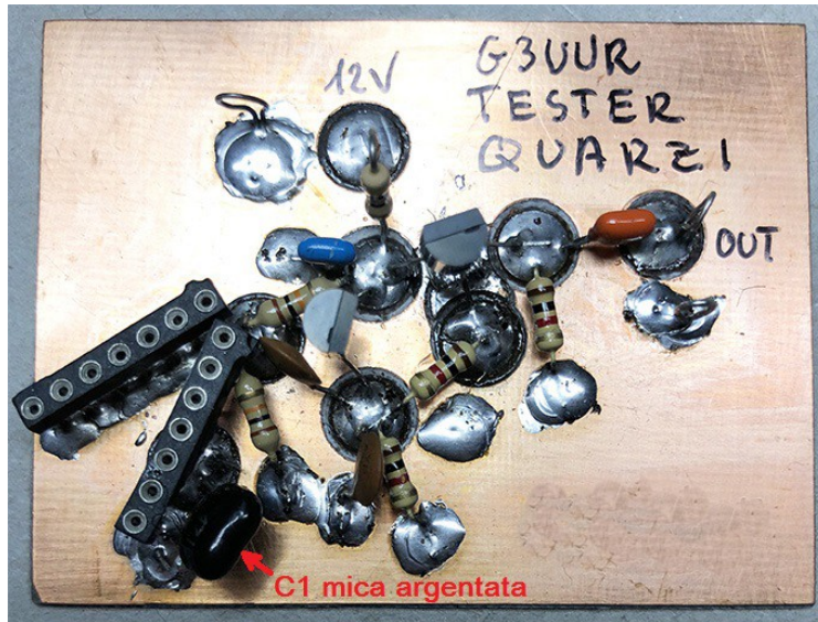
Figura 16-25: Layout oscillatore Colpitts di figura 16-14
