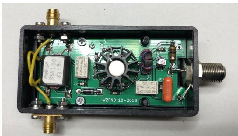
Figura 7: Preamplificatore completo per rombica
