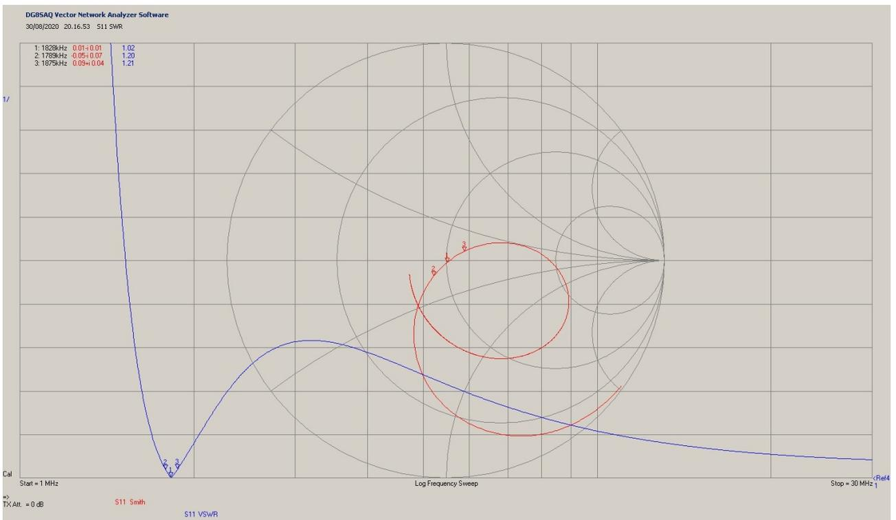
*Figura 14-21: Limite SWR=1,2 tra i marker 2 e 3*
