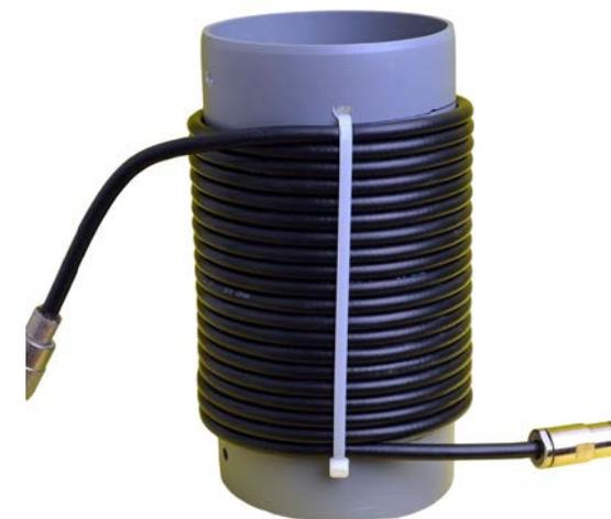
L'effetto bloccante di un circuito così fatto è molto elevato alla frequenza di risonanza perché, di solito, il Q del circuito è piuttosto grande. Purtroppo, la sua frequenza di risonanza è influenzata dalla posa e dai fattori ambientali esterni. Inoltre, questi dispositivi, a causa del Q elevato, non sono in grado di coprire efficacemente più di due o tre bande di frequenza.
